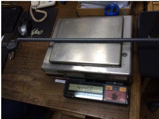
Figura 3. Medición de masa en balanza digital.
