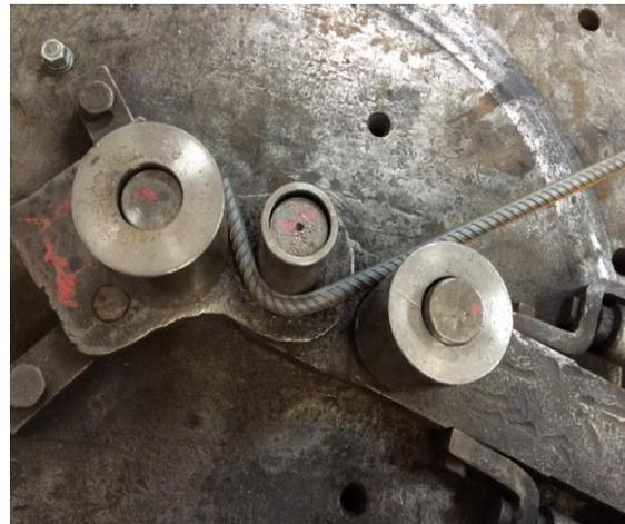
Figura 2. Ensayo de doblado.
